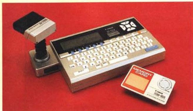
Eccolo qui, probabilmente, il padre di tutti i "palmtop", oggi tanto di moda. E' il Canon X-07, con display grafico, tastiera qwerty e, addirittura, interfaccia opzionale a raggi infrarossi. Non ci crederete, ma il Canon X-07 era un piccolo mostro bi-processore: come vedete l'alta tecnologia era di casa già nel lontano 1985.
